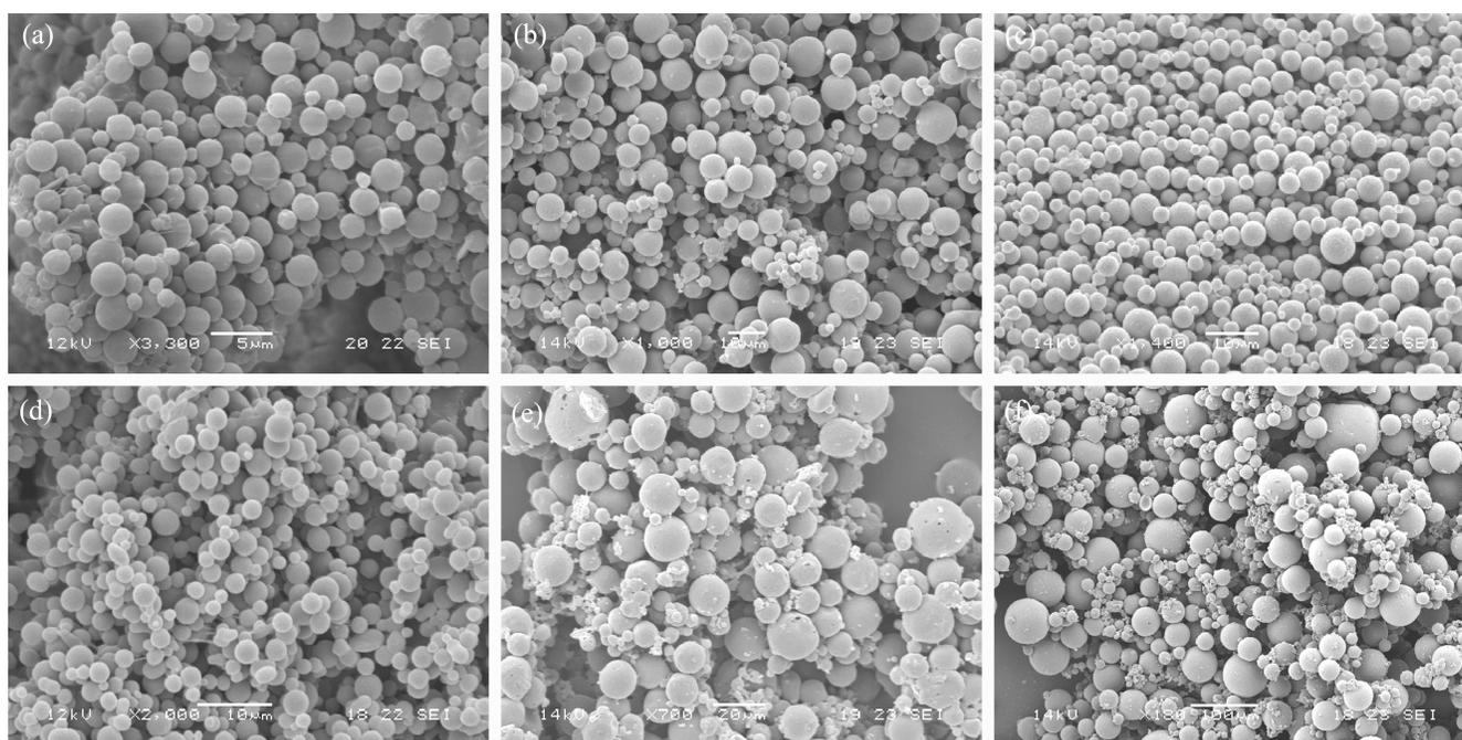
Fig. 3 SEM images of microspheres of C27 (a), dimension bar = 5  $\mu\text{m}$ ; PUC35 (b), dimension bar = 10  $\mu\text{m}$ ; PUC50 only PVA (c), dimension bar = 10  $\mu\text{m}$ ; PUC50 PVA + TW (d), dimension bar = 10  $\mu\text{m}$ ; PUH (e), dimension bar = 20  $\mu\text{m}$ ; PUH (f), dimension bar = 100  $\mu\text{m}$ .
